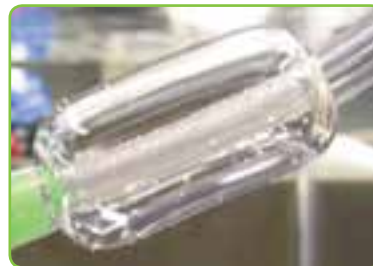
Illustration 2 : une condensation apparaît sur la tige de la sonde.
